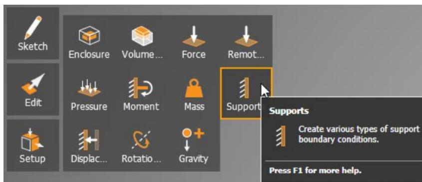
Добавлено 4 новых типа закреплений **Support**. Каждый из них может быть определен для локальной поверхности или в глобальной системе координат.
